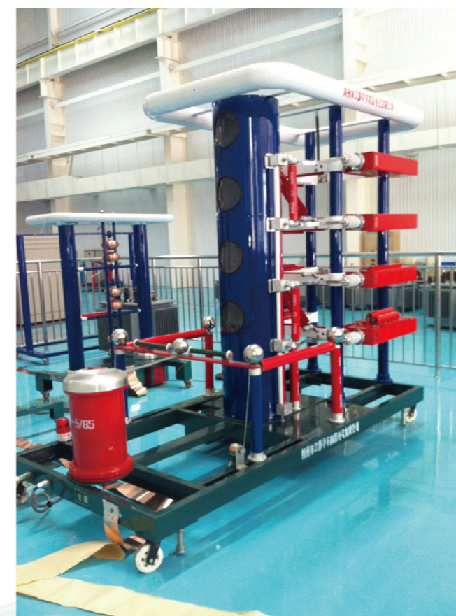
冲击电压发生器 Impulse voltage generator
